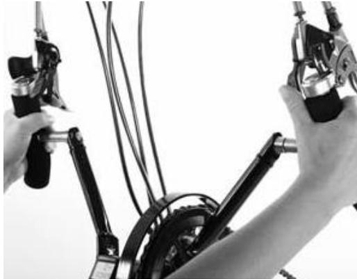
Der Schalthebel zur Betätigung des Schaltwerks für den 9fach Kassettenzahnkranz befindet sich am rechten Griff und der Schalthebel zur Betätigung des Umwerfers für die 3fach Kettenradgarnitur befindet sich am linken Griff (nicht bei RTB). Durch Drücken mit dem Daumen wird jeweils auf ein größeres Ritze / Kettenrad geschaltet. Durch Ziehen mit dem Zeigefinger wird jeweils auf ein kleines Ritzel / Kettenrad geschaltet.
