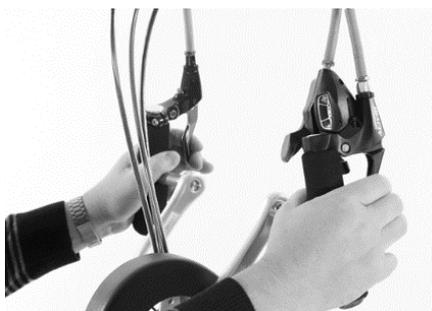
Der Bremshebel der Scheibenbremse sitzt am rechten Griff und der Bremshebel der V-Brake-Bremse sitzt am linken Griff. Es sollten immer beide Bremsen gleichzeitig und gleichmäßig benutzt werden..
