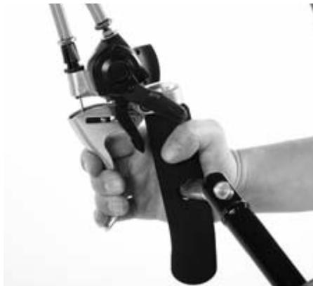
Im Laufe der Zeit wird, aufgrund der Abnutzung der Bremsbeläge und der natürlichen „Streckung“ der Bowdenzüge, die Bremswirkung nachlassen.
