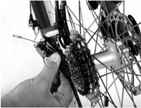
Durch Herausdrehen der Bowdenzug-Stellschraube in kleinen Schritten können Sie das Schaltwerk wieder soweit zurückstellen, dass die Kette mit Hilfe des Schaltwerkrades mittig über dem entsprechenden Ritzel geführt wird.
