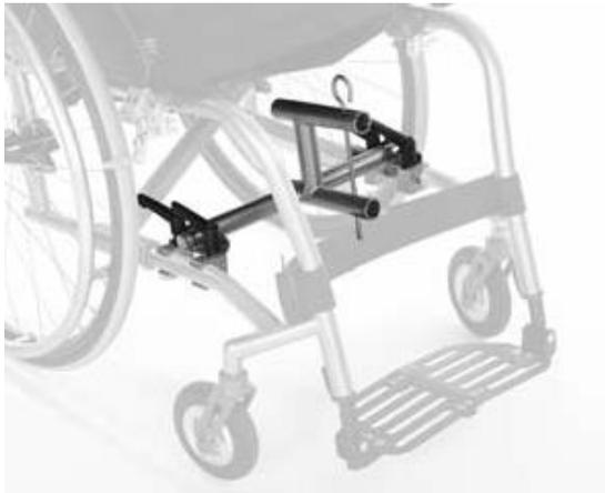
Lösen Sie zunächst die vier Hebelmuttern. Um die Kupplung einsetzen zu können reicht es aus, die Hebelmuttern um eine halbe bis ganze Umdrehung zu lösen. Beim Lösen der Hebelmuttern können die Hebel an Teile des Rollstuhls oder des Kupplungssystems stoßen, so dass sie nicht komplett herumgedreht werden können. Ziehen Sie dann den Hebel senkrecht von der Mutter und drehen Sie ihn zurück. Die Mutter dreht sich dabei nicht
