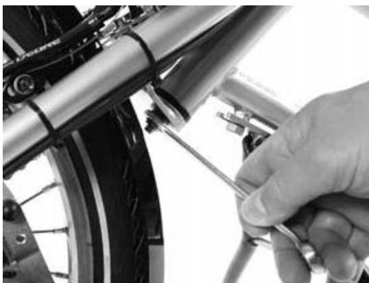
Beim Speedy-B26 befindet sich im Steuerkopf ein Lenkungsdämpfer, durch den die Trägheit der Lenkung individuell und stufenlos eingestellt werden kann. Mit dem Lenkungsdämpfer können Sie die Kraft, die für die Lenkbewegung aufzubringen ist, selbst wählen. Durch das vorsichtige Lösen oder Festziehen der Mutter verändern Sie die Trägheit der Lenkung, bis die gewünschte Dämpfung erreicht ist. Drehen
