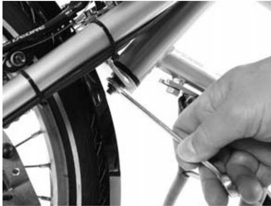
Durch das vorsichtige Lösen oder Festziehen der Mutter verändern Sie die Trägheit der Lenkung. Drehen Sie die Mutter hierbei jeweils nur um max. eine Vierteldrehung und testen Sie dann das erreichte Ergebnis. Vermeiden Sie eine zu feste (Schwergängigkeit der Lenkung) oder zu lose Stellung der Mutter (möglicher Verschleiß innerhalb des Lenkmechanismus).
