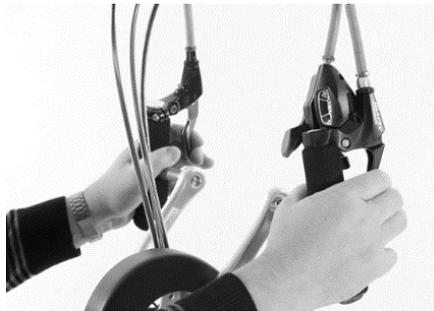
Der Bremshebel der Scheibenbremse befindet sich am rechten Griff und der Bremshebel der V-Brake-Bremse am linken Griff. Es sollten immer beide Bremsen gleichzeitig und gleichmäßig benutzt werden. Vermeiden Sie möglichst, dass beim Bremsen das Antriebsrad blockiert.
