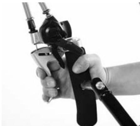
Im Laufe der Zeit wird, aufgrund der Abnutzung der Bremsbeläge und der „Streckung“ der Bowdenzüge, die Bremswirkung nachlassen.
