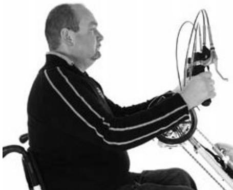
Das Speedy-Versatio F wird über die Griffe durch Drehen der Kurbeln angetrieben.
