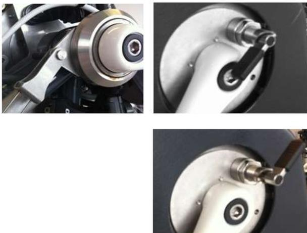
Durch den Kipphebel auf der rechten Kurbelseite wird der Mechanismus der RTB aktiviert oder deaktiviert. In eingerasteter Stellung haben die Kurbeln Kontakt zur Kette. Antrieb und Bremsen sind funktionsbereit.
