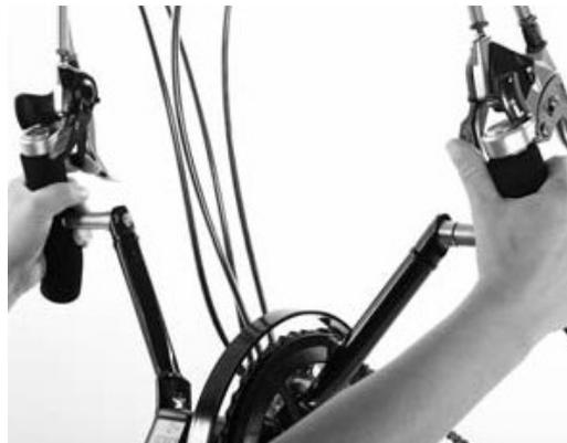
Der Schalthebel zur Betätigung des Schaltwerks für den Kassettenzahnkranz befindet sich am rechten oder linken Griff oder am Rahmen. Durch Drehen des Dehgriffschalters, bzw. Ziehen mit dem Zeigefinger wird jeweils auf ein größeres Ritzel / Kettenrad geschaltet. Durch Zurückdrehen bzw. durch Drücken des Rasterschalters mit dem Daumen wird jeweils auf ein kleineres Ritzel / Kettenrad geschaltet.
