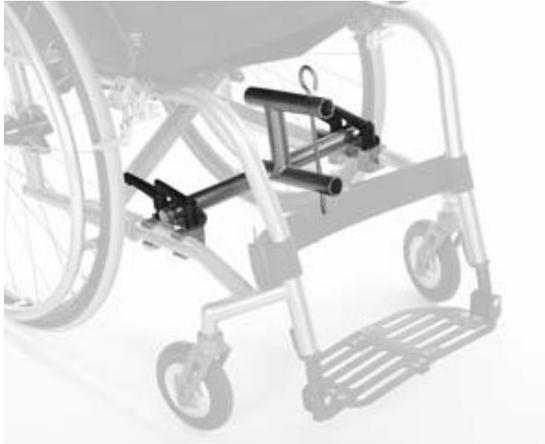
Lösen Sie zunächst die vier Hebelmutter. Um die Kupplung einsetzen zu können reicht es aus, die Hebelmutter um eine halbe bis ganze Umdrehung zu lösen. Beim Lösen der Hebelmutter können die Hebel an Teile des Rollstuhls oder des Kupplungssystems stoßen, so dass sie nicht komplett herum gedreht werden können. Ziehen Sie dann den Hebel senkrecht von der Mutter und drehen Sie ihn zurück. Die Mutter dreht sich dabei nicht mit. Hebel und Mutter
