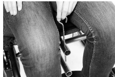
Heben Sie den Rahmen des Zwischenrades, incl. Ständer, etwas an. Ziehen Sie den Rollstuhl an das geöffnete Liftsystem heran. Lenken Sie dabei so, dass die Liftsystemrohre bis zum Anschlag in die Kupplungsrohre geführt werden.
