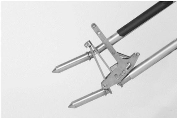
Beim Automatischen Liftsystem sollte in regelmäßigen Abständen die Führungsnut und der Führungsstift auf beiden Seiten des Automatischen Liftsystems nachgefettet werden. Verwenden Sie Standard-Mehrzweckfett (erhältlich in jedem Baumarkt oder Fahrradgeschäft) und tragen Sie das Fett z.B. mit einem kleinen Pinsel auf die Führungsnut auf.
