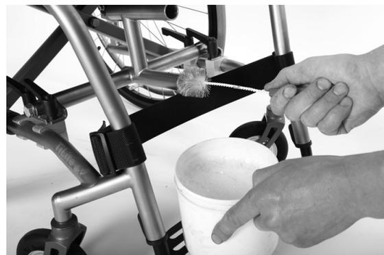
Auf keinen Fall dürfen die Kupplungsrohre eingeölt werden. Öl würde Sand, Staub und Straßenschmutz verstärkt aufnehmen und es würde zu einer noch höheren Schwergängigkeit beim An- und Abkuppeln führen.
