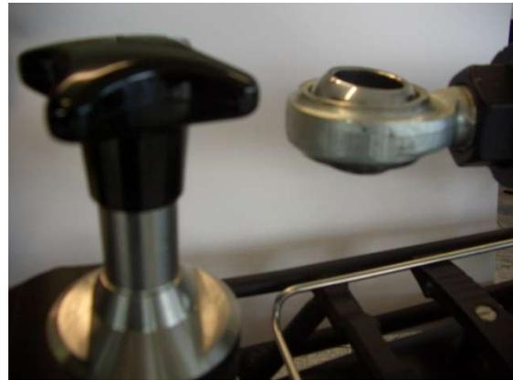
Jetzt kann die Zugdeichsel mit dem Gelenklager von der Zugvorrichtung nach oben abgehoben werden. Um den Sterngriff nicht zu verlieren und um das Gewinde im Bolzen gegen Verschmutzung zu schützen empfehlen wir, den Sterngriff jetzt wieder in den Bolzen zu schrauben und „handfest“ anzuziehen.
