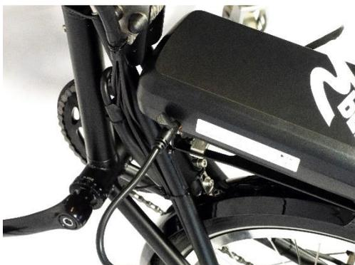
Laden Sie den Akku ausschließlich mit dem mitgelieferten Original-Ladegerät. Schließen Sie dazu das Ladegerät an der Ladebuchse an. Erst dann verbinden Sie das Ladegerät mit der Stromzufuhr.
