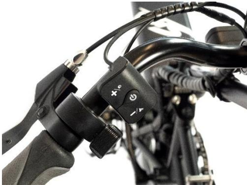
Der Antrieb kann bis zu einer Geschwindigkeit von 6 km/h rein elektrisch erfolgen. Dazu nutzen Sie die Anfahrhilfe. Wählen Sie über das Display eine Unterstützungsstufe 1 bis 5. Der Drehschalter für die Anfahrhilfe ist am Lenker, neben dem Bedienpanel, montiert. Drehen Sie den Schalter nach rechts. Der Motor fährt nun bis maximal 6km/h ohne Kurbelbewegung. Nutzen Sie diese Anfahrhilfe
