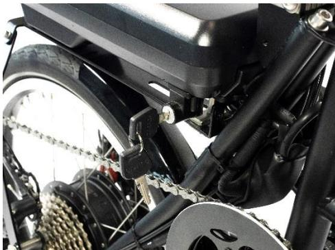
Achten Sie darauf, dass der Akku fest auf der Akkuschiene montiert ist. Die Montage erfolgt ohne Schlüssel. Sie benötigen den Schlüssel nur zur Abnahme des Akkus. **Es ist zwingend erforderlich immer den Schlüssel aus dem Akkuschloss zu entfernen!**
