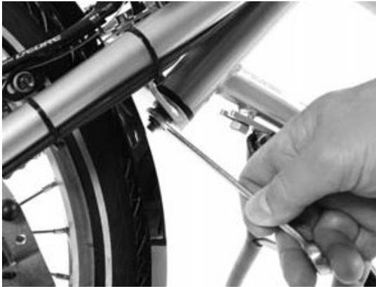
Durch das vorsichtige Lösen oder Festziehen der Mutter verändern Sie die Trägheit der Lenkung. Drehen Sie die Mutter hierbei jeweils nur um max. eine Viertelumdrehung und testen Sie dann das erreichte Ergebnis. Vermeiden Sie eine zu feste (Schwergängigkeit der Lenkung) oder zu lose Stellung der Mutter (möglicher Verschleiß innerhalb des Lenkmechanismus).
