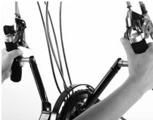
Der Schalthebel zur Betätigung des Schaltwerks für den 8fach bzw. 9fach Kassettenzahnkranz befindet sich am rechten Griff. Der Schalthebel zur Betätigung des Umwerfers für die 3fach Kettenradgarnitur befindet sich am linken Griff (nicht bei RTB). Durch Drehen des Dehgriffschalters, bzw. Drücken des Rasterschalters mit dem Daumen, wird jeweils auf ein größeres Ritzel / Kettenrad geschaltet. Durch Zurückdrehen
