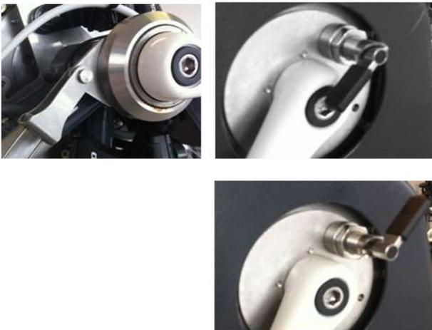
Durch den Kipphebel auf der rechten Kurbelseite wird der Mechanismus der RTB aktiviert oder deaktiviert. In eingerasteter Stellung haben die Kurbeln Kontakt zur Kette. Antrieb und Bremsen sind funktionsbereit.
