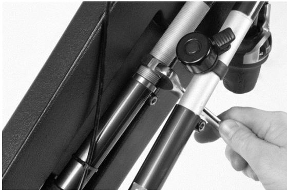
Lösen Sie die beiden Höhenverstellerschrauben am Rahmen. Drehen Sie die Kettenspannmutter hinauf bzw. hinunter bis die optimale Kettenspannung erreicht ist.
