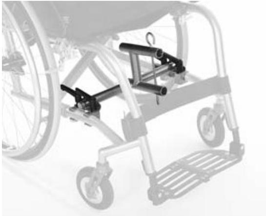
Lösen Sie zunächst die vier Hebelmutter. Um die Kupplung einsetzen zu können reicht es aus, die Hebelmutter um eine halbe bis ganze Umdrehung zu lösen. Beim Lösen der Hebelmutter können die Hebel an Teile des Rollstuhls oder des Kupplungs-systems stoßen, so dass sie nicht komplett herum gedreht werden können. Ziehen Sie dann den Hebel senkrecht von der Mutter und drehen Sie ihn zurück. Die Mutter dreht sich dabei nicht mit. Hebel und Mutter greifen
