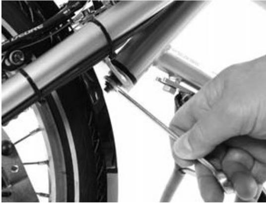
Die Trägheit der Lenkung können Sie einstellen, indem Sie die Lenkungsdämpfermutter lösen bzw. festschrauben, bis die gewünschte Dämpfung erreicht ist.
