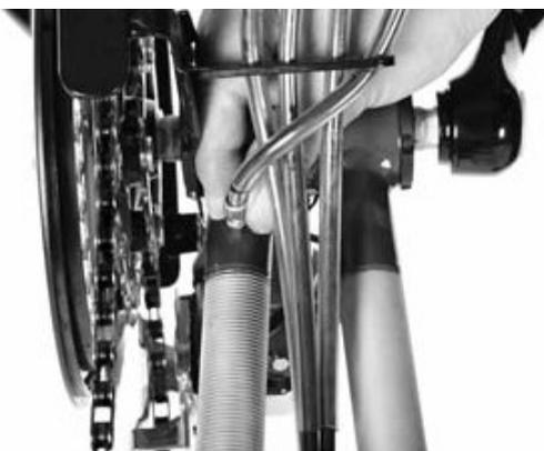
Lösen Sie die Kontermutter der Bowdenzug-Stellschraube des Umwerfers. Sie können jetzt durch Herausdrehen der Bowdenzug-Stellschraube in kleinen Schritten den Umwerfer wieder soweit zurückstellen, dass die Kette mittig über dem entsprechenden Kettenrad geführt wird. Drehen Sie die Kontermutter wieder fest!
