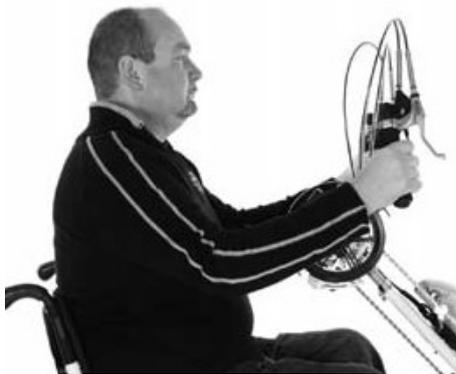
Das Speedy-B26 wird über die Griffe durch Drehen der Kurbeln angetrieben.
