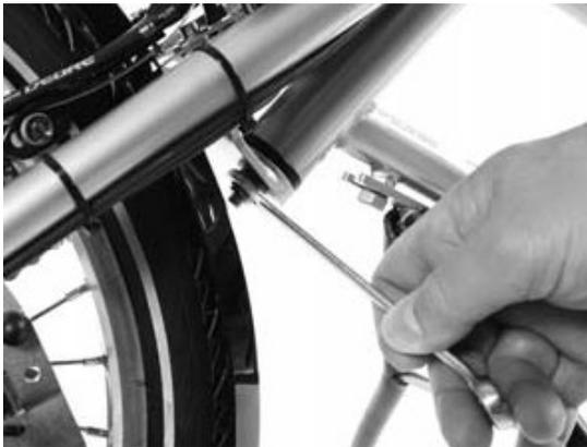
Durch das vorsichtige Lösen oder Festziehen der Mutter verändern Sie die Trägheit der Lenkung, bis die gewünschte Dämpfung erreicht ist. Drehen Sie die Mutter hierbei jeweils nur um max. eine Viertelumdrehung und testen Sie dann das erreichte Ergebnis. Notfalls wiederholen Sie diesen Schritt mehrmals. Vermeiden Sie eine zu feste (Schwergängigkeit der Lenkung) oder zu lose Stellung der Mutter (möglicher Verschleiß innerhalb des Lenkmechanismus).
