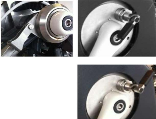
Durch den Kipphebel auf der rechten Kurbelseite wird der Mechanismus der RTB aktiviert oder deaktiviert. In eingerasteter Stellung haben die Kurbeln Kontakt zur Kette. Sowohl Vortrieb als auch beide Bremsen sind funktionsbereit. Durch Verdrehen des Kipphebels lösen Sie die mechanische Verbindung zwischen Kurbeln und Kette. Jetzt können Sie die Kurbeln frei vorwärtsdrehen bzw. beim
